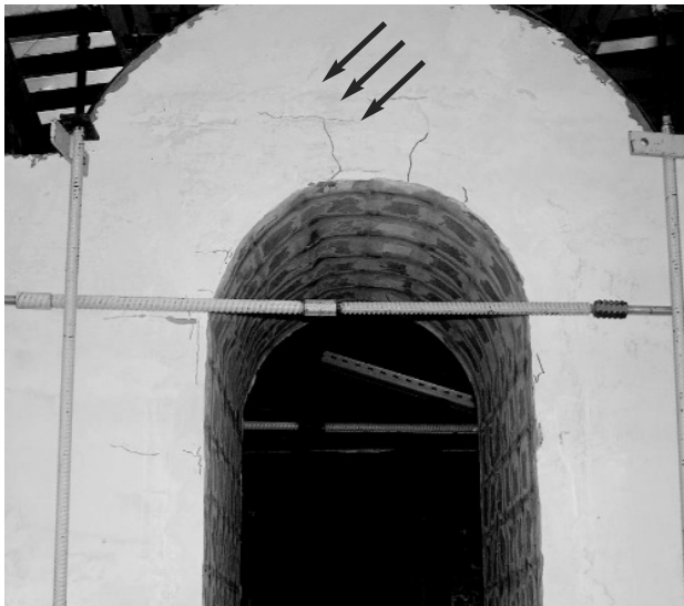
Рис. 7. Характер деформації отриманий під час першого етапу випробувань
